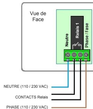
**ATTENTION** : les lampes de lumière froide, halogènes ou fluorescents électroniques, malgré leur basse consommation, produisent des pics de courant très élevés (celles de lumière froide environ 20Amp.) lorsqu'on les allume ou qu'on les éteint, ce qui accélère la détérioration des bornes contact du relais. Pour cette raison, si ce type d'équipement est installé, Onity recommande fortement d'utiliser un contacteur ou un relais externe d'au moins 20A.
